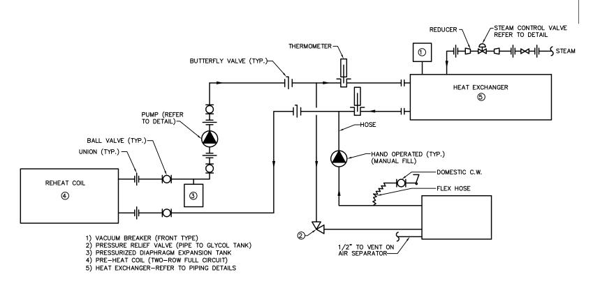
SEQUENCE: WHENEVER O.A. TEMPERATURE IS BELOW 50 F, THE CIRCULATING PUMP IS ENERGIZED AND THE STEAM VALVE (VPH) IS CONTROLLED TO MAINTAIN THE DISCHARGE TEMPERATURE. WHEN THE O.A. TEMPERATURE IS ABOVE 50 F, THE PUMP IS OFF AND VHP IS CLOSED.
